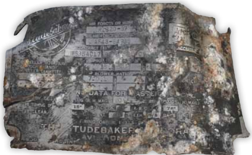
Het motorplaatje waardoor de B-17 geïdentificeerd kon worden.
